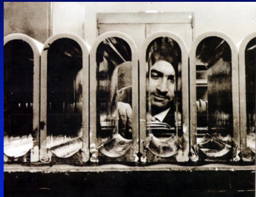
Attività di controllo su di una sezione di una camera da vuoto del Sincrotrone (nella foto, Clozza).
